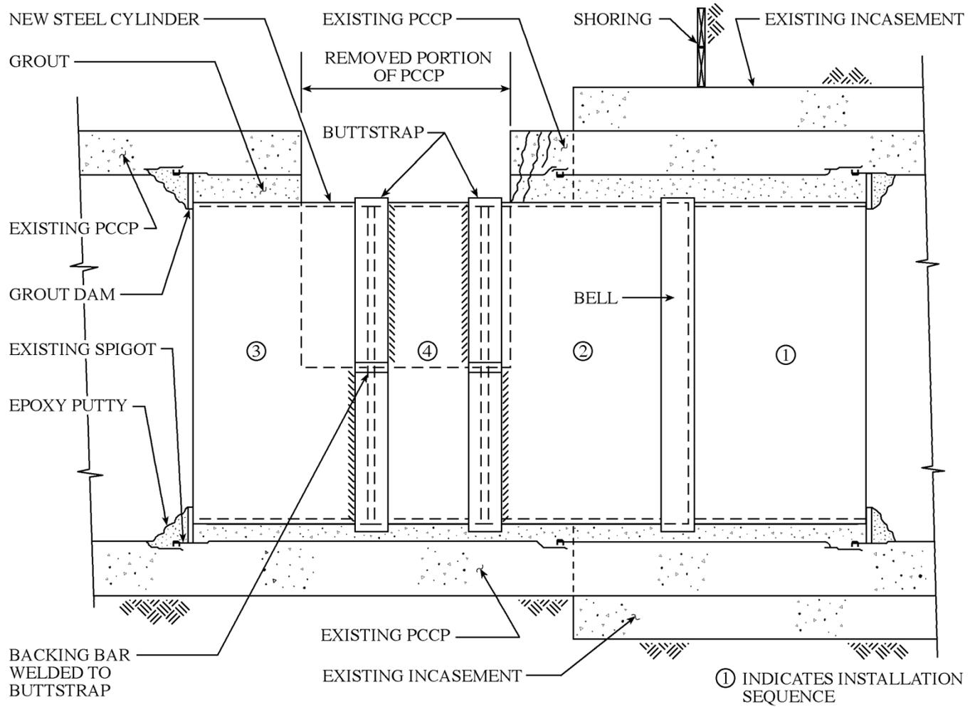
**DETAIL OF INTERNAL STEEL CYLINDERS - FIGURE 3**
